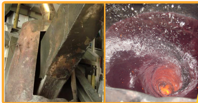
Situazione all'ingresso medesimo forno con materiale trattato PROVENIENTE dal nostro SISTEMA CDS Situation of the same Melting Furnace with material deriving by DRYER SYSTEM CDS
