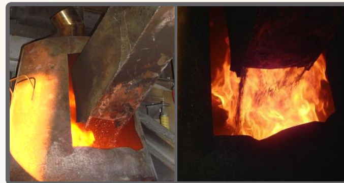
Situazione all'ingresso del forno con materiale NON proveniente dal sistema di trattamento CDS Situation of the entry zone of the Melting Furnace with material NOT deriving by the dryer system CDS
